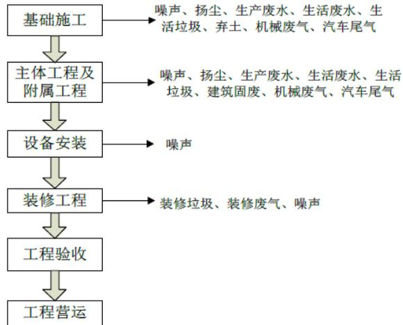
图2-2 项目施工期工艺流程及产污位置图
